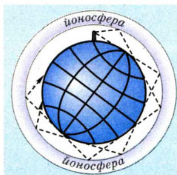
Мал. 3.21. Короткі радіохвилі відбиваються від йонізованого шару повітря
