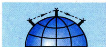
Мал. 3.23. У системах радіозв'язку на ультракотких хвилях застосовують лінії з ретрансляторами
