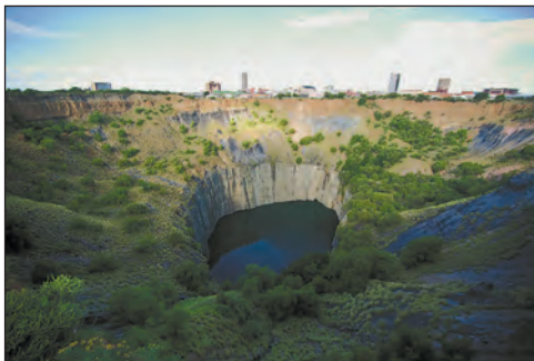
Мал. 3. Кар'єр із видобутку алмазів «Велика діра». Тривалий час роботи в Кімберлі велися відкритим способом. На згадку про той час залишився величезний заповнений водою кар'єр діаметром у 1,5 км і глибиною майже 200 м.
