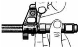
4. Відокремити дульне гальмо-компенсатор
