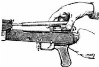
7. Відокремити затворну раму із затвором
