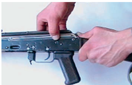
• Від'єднання кришки ствольної коробки
