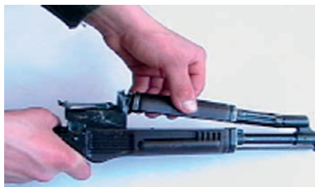
• Від'єднання газової трубки зі ствольною накладкою
