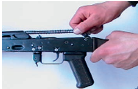
• Від'єднання зворотного механізму
