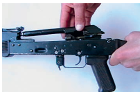
• Від'єднання затворної рами з затвором
