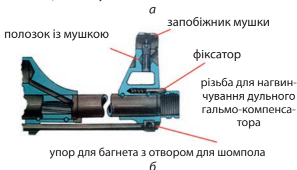
• Прицільний пристрій: а – приціл; б – мушка
