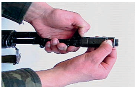
• Від'єднання від автомата дульного гальмо-компенсатора
