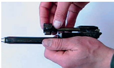
• Від'єднання затвора від затворної рами
