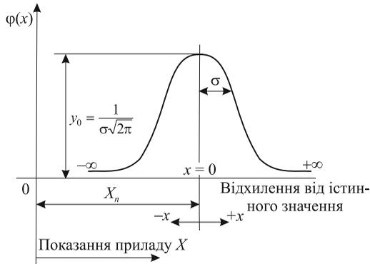
Рис. 7. Типова крива розподілу обмірюваних значень
