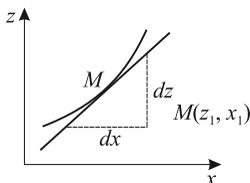
Рис. 16. Визначення похідної  $dz / dx$  в точці  $M(z_1, x_1)$  при визначенні похибки результату  $z$
