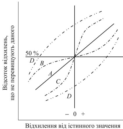
Рис. 12. Графіки, побудовані на імовірнісному папері для наступних розподілів: *A* – нормальне; *B* – симетричне, більш плосковершинне, чим нормальне; *C* – симетричне, більш гостровершинне, чим нормальне; *D* – два асиметричних розподіли
