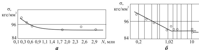
Рис. 40. Залежність утоми зразків сталі ШХ15 після загартування і відпуску при  $150^\circ$ : **а** – лінійні шкали; **б** – напівлогарифмічний графік (помітна чітко виражена границя витривалості)
