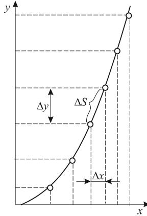
Рис. 21. Графік з однаковими інтервалами між експериментальними точками
