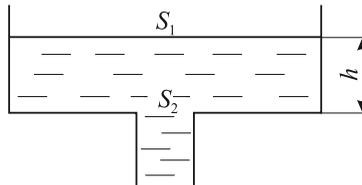
Рис. 17. До прикладу 4.1. Визначення часу  $t$  витікання рідини через отвір перетину  $S_2$
