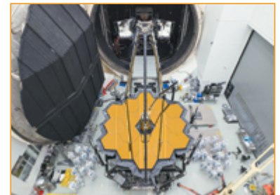
Рис. 3.2 Сегментоване дзеркало новітнього космічного телескопа «Джеймс Вебб»
