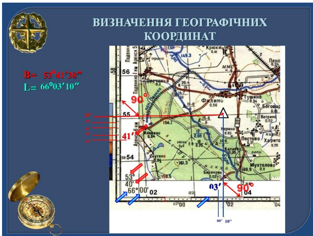
Рис. 2. Визначення географічних координат точки на топографічній карті.
