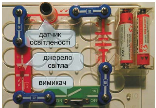
Мал. 8. Електричне коло з джерела струму, фотоопору, світлодіоду і вимикача (діючий макет)
