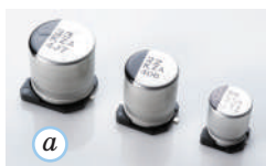
Рис. 33.3. Різні типи конденсаторів: a — полімерні; б — електролітичні; в — керамічні; г — паперовий
