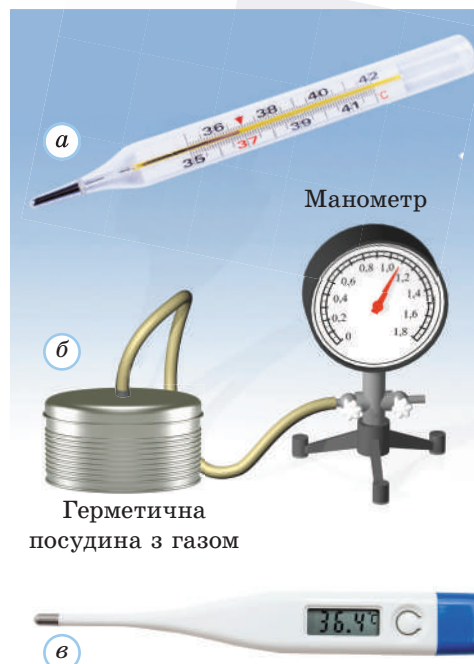
Рис. 22.2. Термометри: а — рідинний; б — газовий; в — електронний
