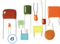
Рис. 33.3. Різні типи конденсаторів: a — полімерні; б — електролітичні; в — керамічні; г — паперовий
