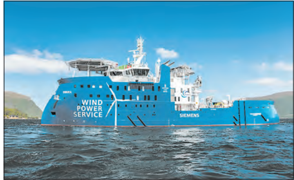
Мал. 2. Унікальне судно для обслуговування вітрових електростанцій, побудоване для німецької компанії.
