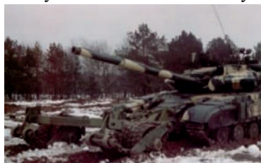
Іл. 12.3. Танк з мінним тралом
