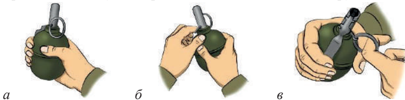
Іл. 4.2. Підготовка гранати до метання: а — притиснути спусковий важіль до корпусу гранати; б — випрямити кінці запобіжної чеки; в — висмикнути запобіжну чеку
