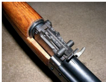
Іл. 13.7. Приціл автомата, встановлений для стрільби «на дальність 100 м»
