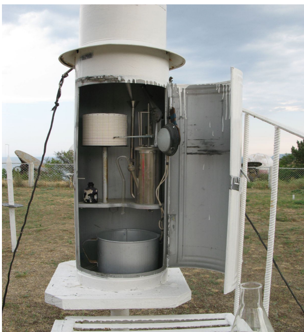
Рисунок 2.13. Плювіограф у роботі на метеорологічному майданчику
