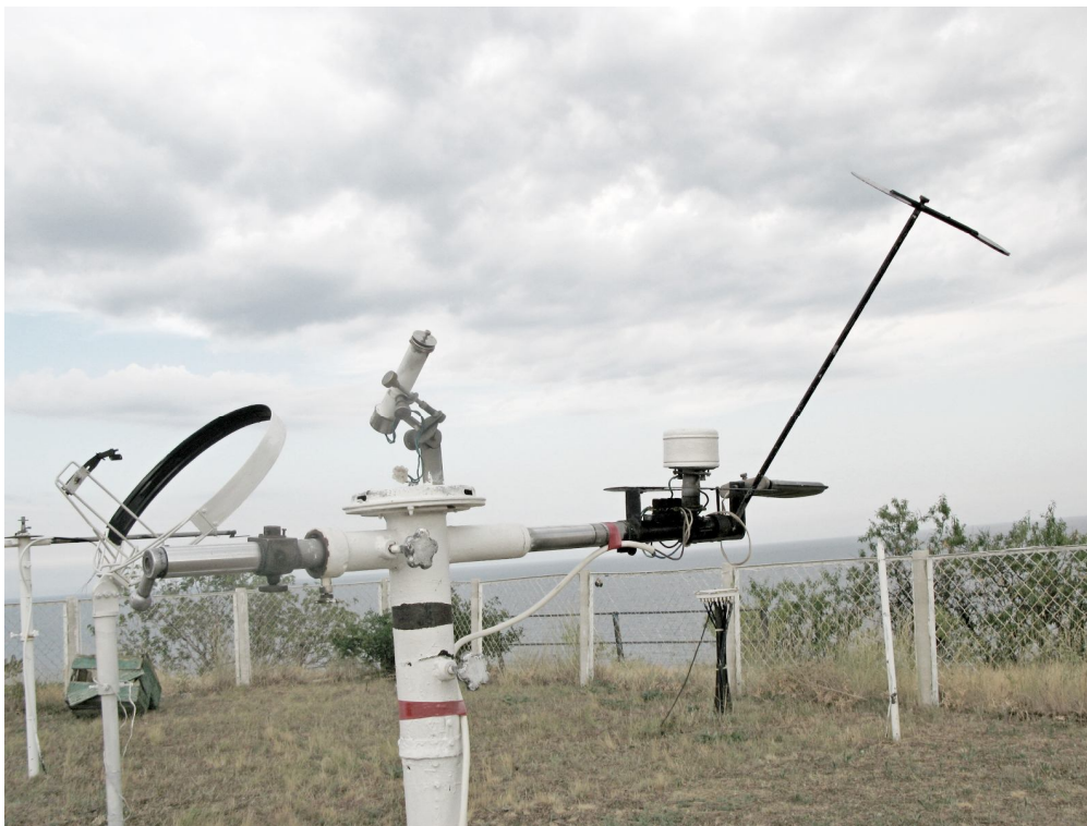
Рисунок 1.3. Актинометричний комплекс приладів
