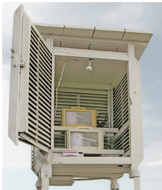
Рисунок 1.5. Розміщення самописних приладів у психрометричній будці
