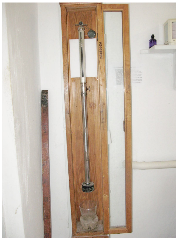
Рисунок 2.5. Ртутний барометр на сучасній метеостанції
