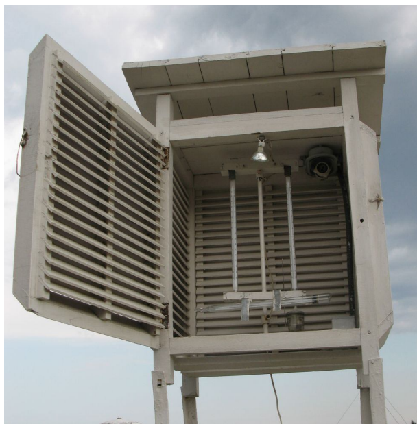
Рисунок 1.4. Термометри у психрометричній будці
