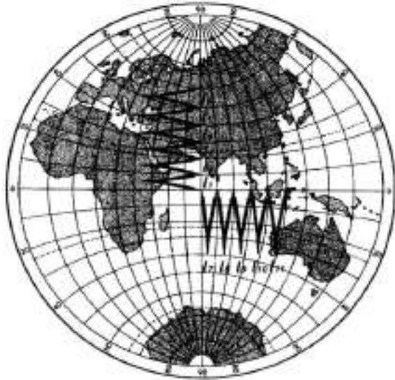
Рис. 37. Зміна довжин дуг середнього меридіана між сусідніми паралелями та екватором і між сусідніми меридіанами при віддаленні від центра півкулі до її країв.
