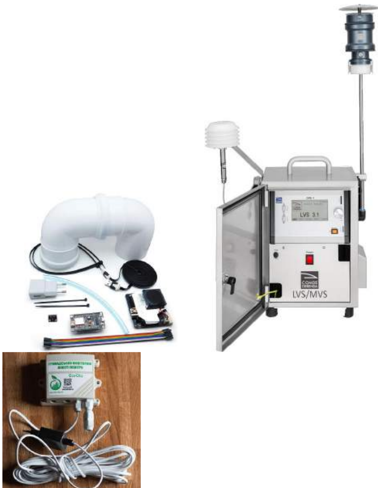
Рис. 2.10. Порівняння обладнання для вимірювання концентрації ТЧ_{10} та ТЧ_{2,5} Sensor.community KIT (SDS011/BME280), Німеччина вартістю 52,3 євро ( https://nettigo.eu/products/nova-fitness-sds011-air-quality-sensor ), LVS/MVS Low and Mid Volume Samplers, Німеччина вартістю 8500 USD та вітчизняний датчик AirFresh, Україна вартістю 1200 грн. (станом на початок 2022 р.).
