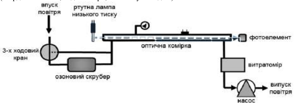
Рис. 2.9. Принципова схема побудови O_3 -спектрометра
