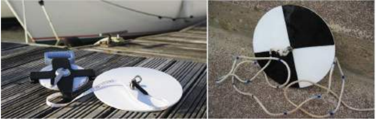
Рис. 3.19 Диск Секкі у виконанні для морських та поверхневих вод
