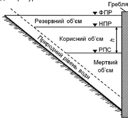
Рис. 7.1. Морфометричні елементи водосховища
